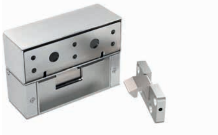
STEP 8 med vinkelkonsol för montering i dörrar där karmen ligger i liv med dörrbladet.
